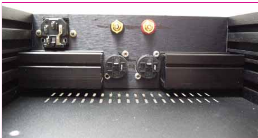
Figura 06: Vista interna pannello posteriore con i dissipatori montati
