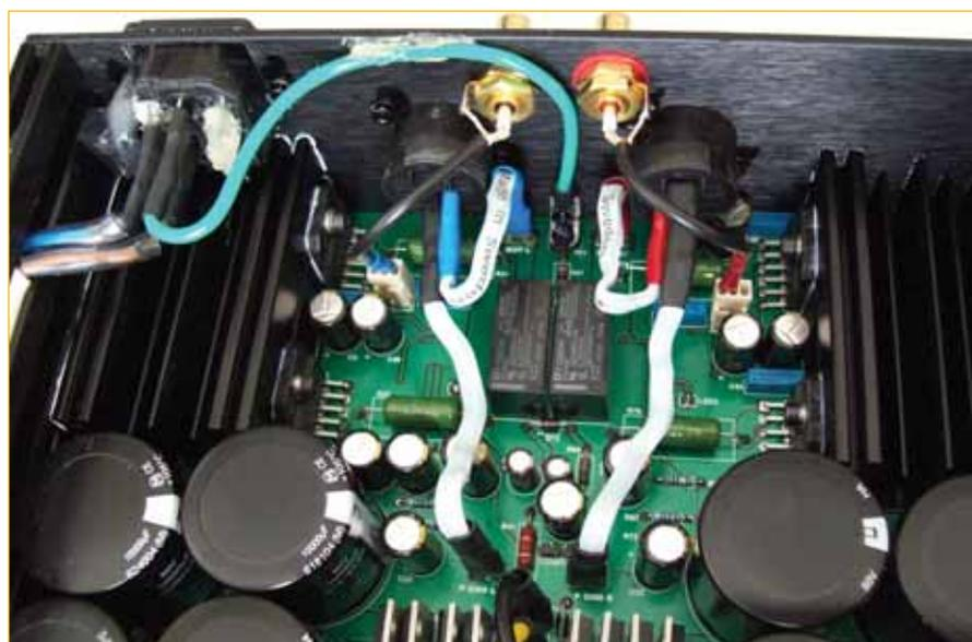
Figura 07: Vista cablaggi di segnale e di terra.
