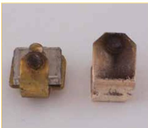
Figura 16: Effetti, nel tempo, degli archi voltaici che si generano tra i contatti di un interruttore.
