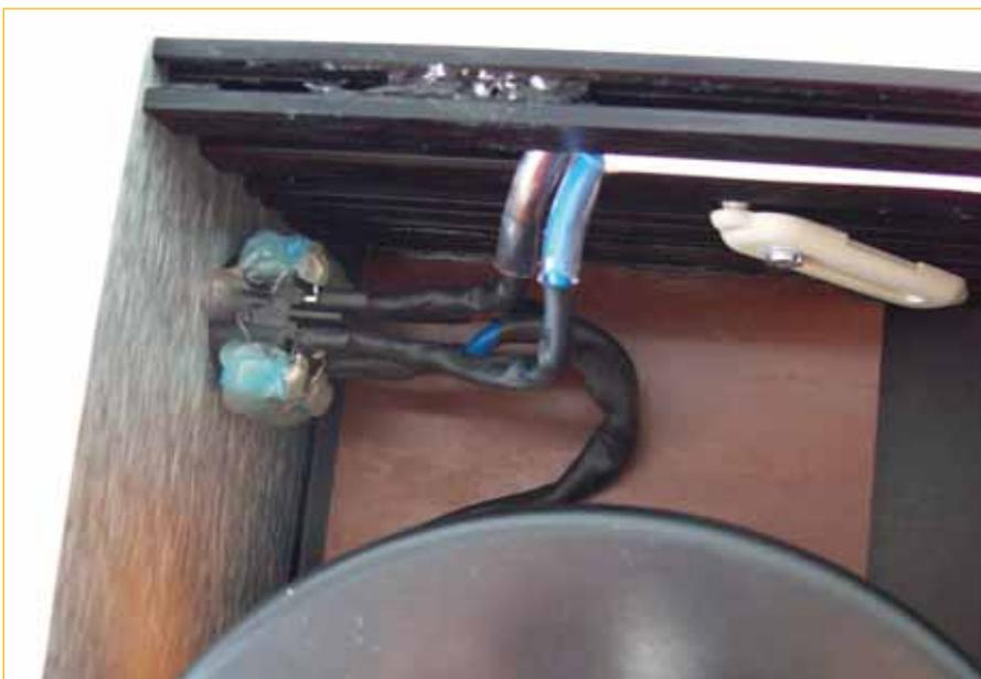
Figura 09: Particolare dell'interruttore di accensione e dei condensatori spegni arco.
