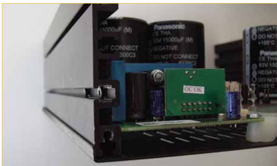
Figura 08: Primo piano dei perni usati per bloccare i moduli.
