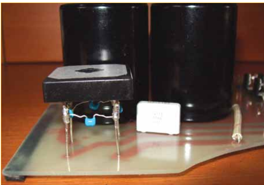
Figura 04: Primo piano dei condensatori anti-interferenze usati.
