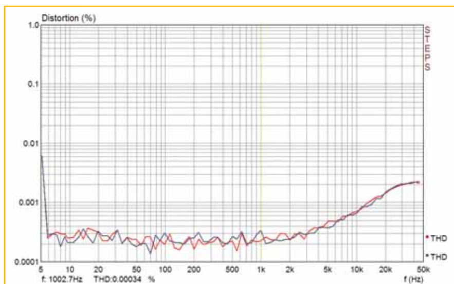
Grafico 02 - Comparativa THD Vs Frequenza tra condensatore d'ingresso in policarbonato (curva rossa) e in poliestere (curva blue).
