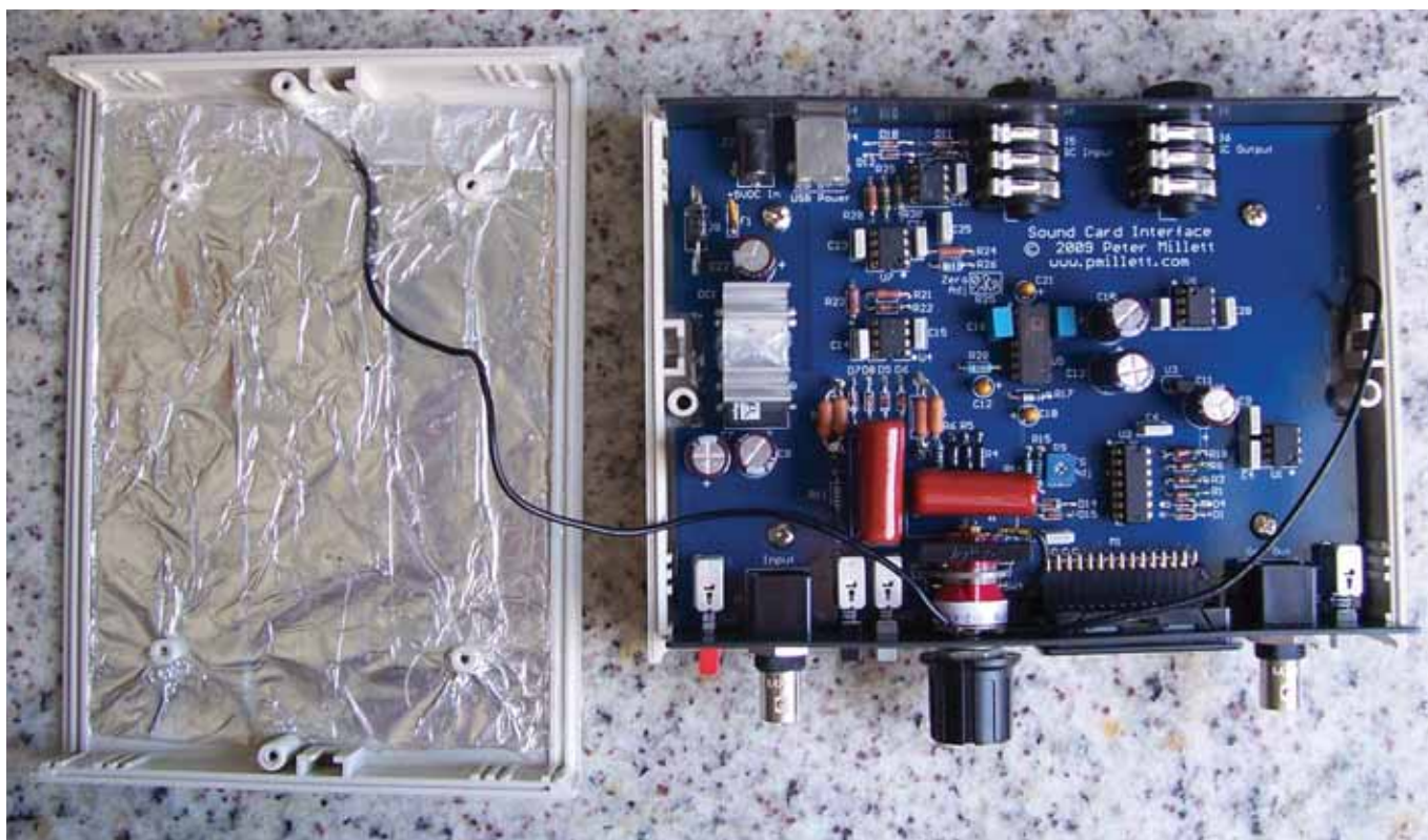
Foto 02 - Interno del JIG e schermatura contenitore.
