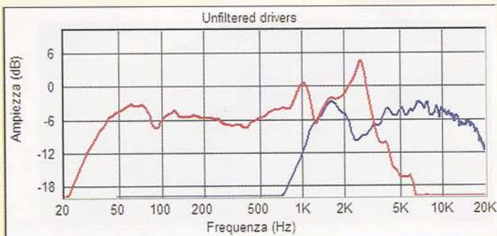
Figura 11: Risposta dei driver in cassa non filtrati
